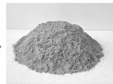
路盤材・建設骨材 としてリサイクル
