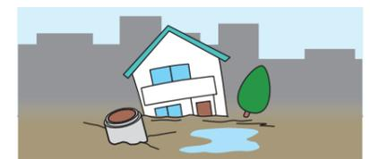
地震の揺れにより液状化が起こり、マンホールが浮き上がったり、建物の倒壊や道路の陥没が発生するおそれがあります。
