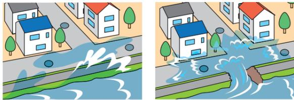
大雨によって河川を流れる水が大幅に増え、堤防から水があふれたり、堤防が決壊することにより、水が流れ出す現象です。
