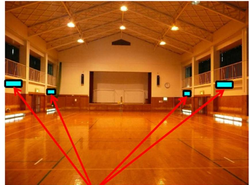
✓ 2階ギャラリーの下に室内機を吊り施工
